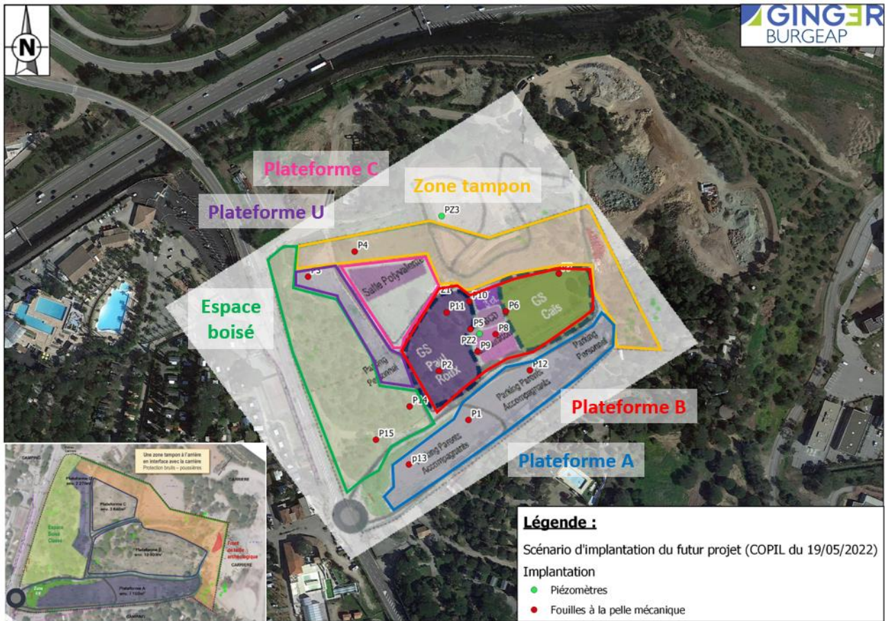
Figure 22 : Localisation des investigations de sols
