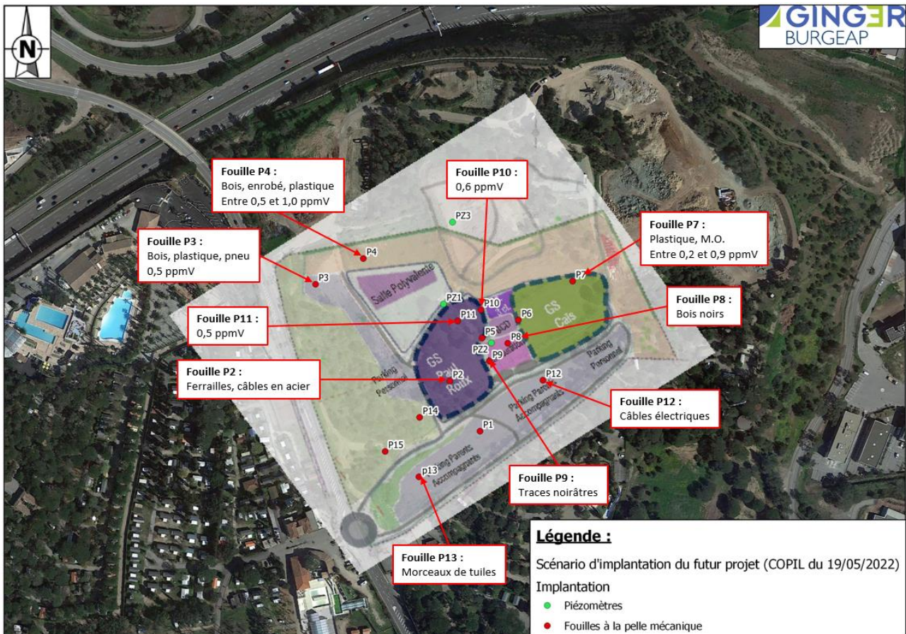
Figure 23 : Localisation des investigations, mesures de terrain et indices de pollution relevés
